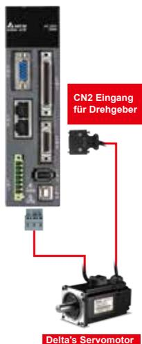
2. Anschluss von Fremdfabrikaten mit Sinusgeber mittels Konverterbox über den CN2 Eingang des ASDA-A2R
