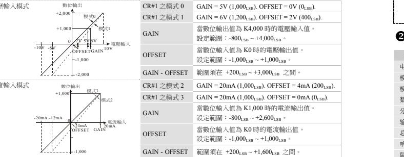
上列表示電壓輸入模式與電流輸入模式之 A/D 轉換特性曲線，使用者可依據實際應用需要來調整轉換特性曲線，調整時以改變 OFFSET 值 (CR#18 ~ CR#21) 及 GAIN 值 (CR#24 ~ CR#27) 來進行。
