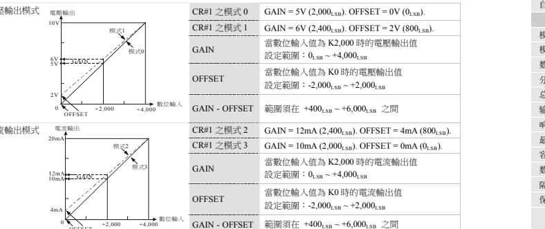
上列表示電壓輸出模式與電流輸出模式之 D/A 轉換特性曲線，使用者可依據實際應用需要來調整轉換特性曲線，調整時以改變 OFFSET 值 (CR#14 ~ CR#15) 及 GAIN 值 (CR#18 ~ CR#19) 來進行。
