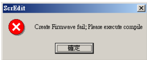
그림. 2.3.16 SMC 화면 데이터를 만들면서 나타나는 장애 메시지 대화 상자
