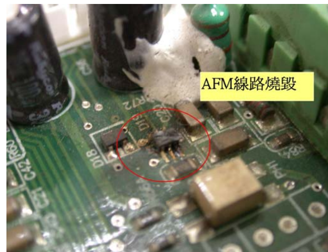
AFM wire burned out/ Yanmış AFM bağlantısı
