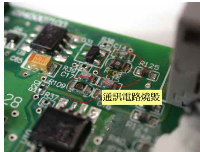
Communication circuit burned out/ Yanmış haberleşme devresi
